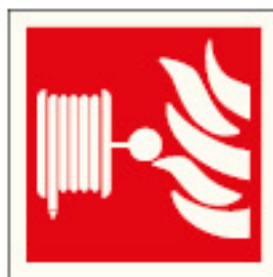
ZP-13 Hydrant wewnętrzny
